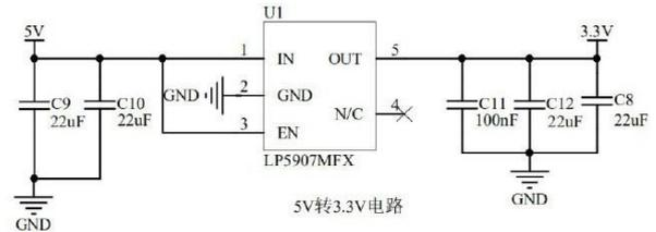
**Fig. 13 LP5907MFX Buck circuit**
